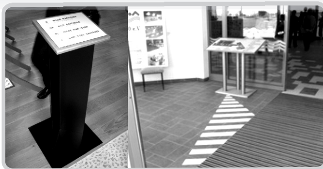
Рис. 73. Трибуны с информацией крупным контрастным шрифтом и шрифтом Брайля
