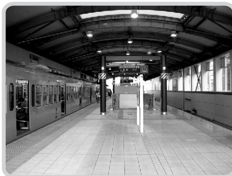
Рис. 90. Тактильные и контрастные направляющие на станции японского метро
