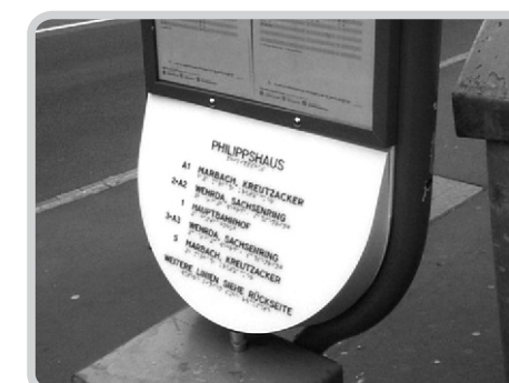
Рис. 89. Информация рельефно-точечным шрифтом Брайля и рельефными знаками на автобусной остановке в Германии
